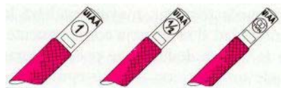
Figura 2. Símbolos en las cuerdas. De izq. a dcha. : Sencilla, doble y gemela
