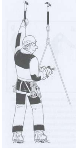
Figura 66. Colocación de un tornillo colgando de un brazo
