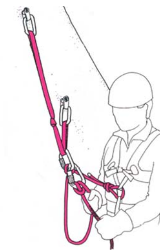
Figura 89. Aseguramiento al segundo con nudo dinámico en una reunión en hielo con triángulo de fuerza anudado
